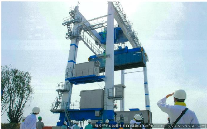
荷役作業を模倣するFC駆動RTGC「ゼロ・エミッショントランスレーナ」
