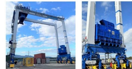
図1 今回実証試験に成功したFCパワーバック搭載のRTGC(左：全体像、右：FCパワーバック搭載部分)
