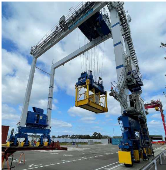
40.6トン模擬コンテナの揚荷
