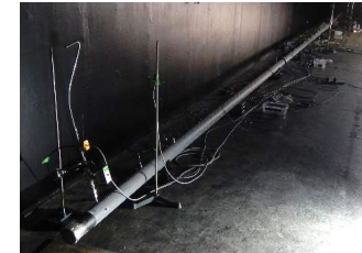
試験用模擬2重管 (外75A鋼管、 内50Aフレキ)
